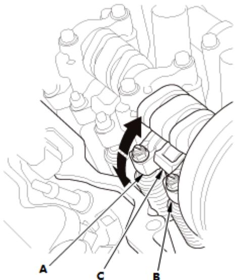
1. 顺时针旋转曲轴皮带轮。确保辅助进气摇臂 (A)、主进气摇臂 (B) 和中间进气摇臂 (C) 已分离，并确保辅助进气摇臂和中间进气摇臂应独立移动：
