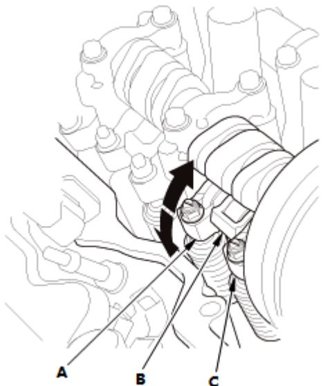
7. 在施加规定的空气压力时，顺时针旋转曲轴皮带轮。辅助摇臂 (A) 应可与中间摇臂 (B) 和主摇臂 (C) 一起移动：
